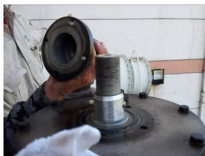
图 4 拆解的将军帽与导杆
